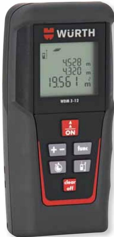
O WDM 3-12 é um medidor de distâncias a laser de alta precisão com especificação técnica (precisão  $\pm 1.0$  mm, alcance de 80 m) que cumpre extensivamente o novo padrão ISO 16331-1. Tem como características adicionais o design da estrutura ergonômico e extremamente resistente, que tornam o WDM 3-12 especialmente fácil de usar.
